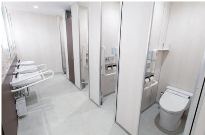
中央診療棟5Fの女性用トイレ。手洗いの一つには手すりを付けるなど、どんな患者さんでも使いやすいように配慮されている。人感センサー式LED照明による、明るい空間である。
