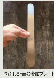
この突起プレートを試作し、障害者施設の一般トイレ内に仮設して視覚障がい者や片麻痺患者に実際に利用してもらい、試作品についての検証を行いました。この障がい者施設では既にUDフロアシステムが導入されていて、1.8mmの突起による誘導経路がトイレの入口を案内しています。その経路に接続する形で、一般トイレ内にステンレス製の突起プレートを配置しました。設置状況は写真の通りです。分岐点には通常点状突起を配置しますが、トイレ内は一直線上であることやメンテナンス面を考慮して線状突起のみで経路を形成しました。
