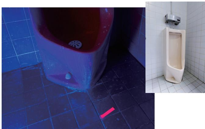
ブラックライトを当てると、紫外線で励起された物質が光ります。有機物以外にも色々な物質が励起してしまうので物質（＝汚れ）の同定は難しいものの、「異物が付着しやすい場所」を傾向として捉えることができます。赤く光る付箋は、実験前に汚染箇所として予測された部分に貼られたもので、小便器下部や足元の床の目地などで多くの反応が確認されました。
