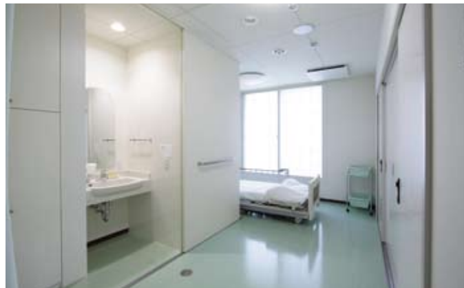
個室ではカーテンとスライド扉を併用し、入口近くに洗面台を設置している。
