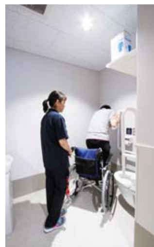
老人保健施設の個室のトイレ。すべてを保護しなくてもよいという判断で、背もたれは設置していない。必要以上の手すりはいらぬという意見もあり、手前は跳ね上げ式を採用している。
