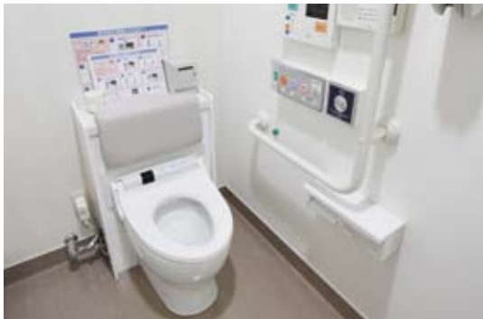
1F泌尿器外来の、患者さんが自分で簡単に操作できる、尿の勢い・出方を調べるトイレ。検査後の後始末はトイレの水を流すだけなので、看護師さんにも喜ばれている。
