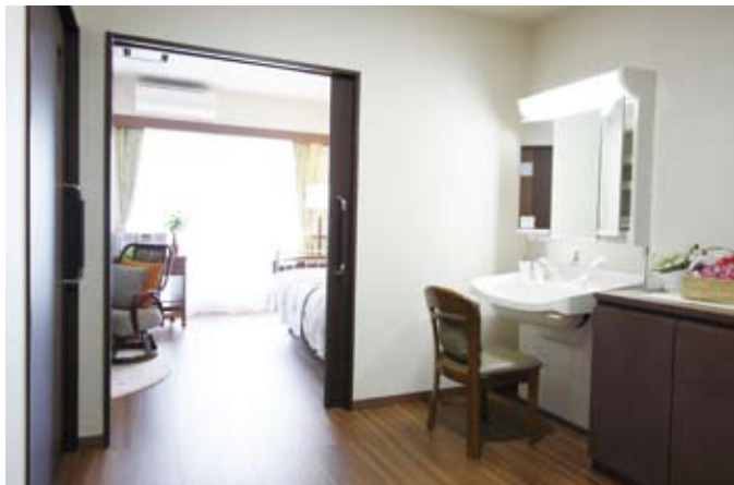
車いすでも使いやすい高さを変えられる洗面器など、居室には使い勝手を高めるための工夫がなされている。
