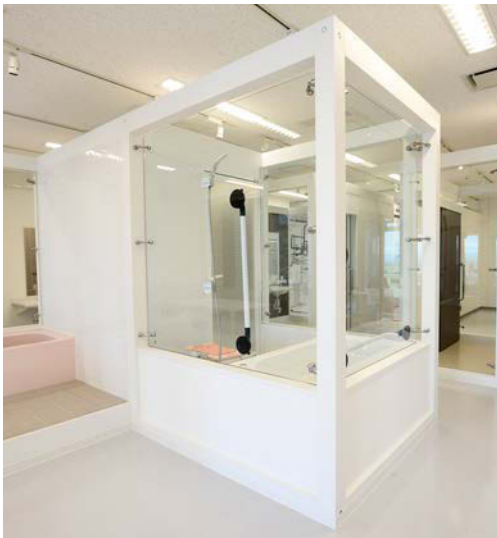
浴室は2タイプ。手すりは吸盤付きで、位置を自由に変えられる。
