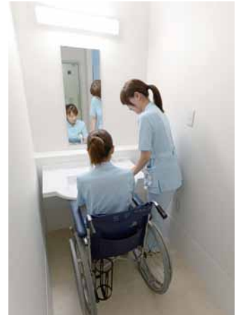
4床室の洗面カウンターは、カウンター横に入って介助ができるように、片側に十分なスペースを確保。また、カウンターの側面もしっかりと清掃できるよう、あえて壁との間に隙間を設けて設置している。
