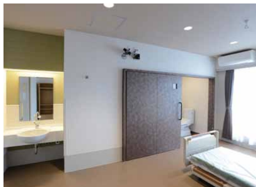
7Fの沖縄をイメージした壁紙の施された個室。1枚引戸で介助もしやすいトイレには、手すりや前方ボードなどが設置されている。
