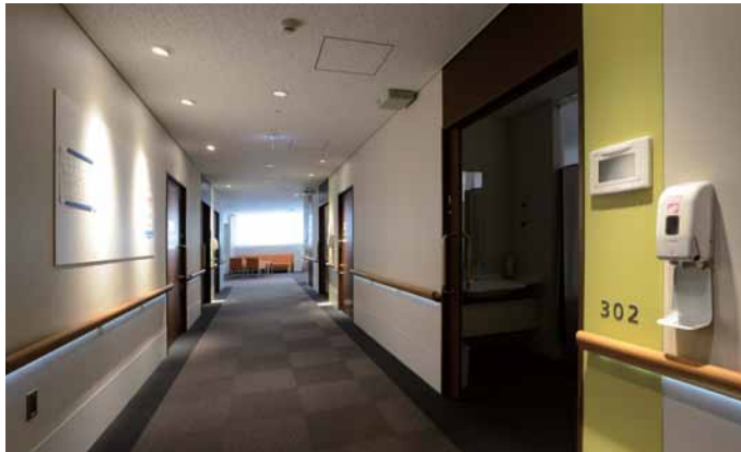
連続した手すりが病室へ誘導。災害時には手すりに埋め込まれた照明が火元と反対方向へ誘導する。
