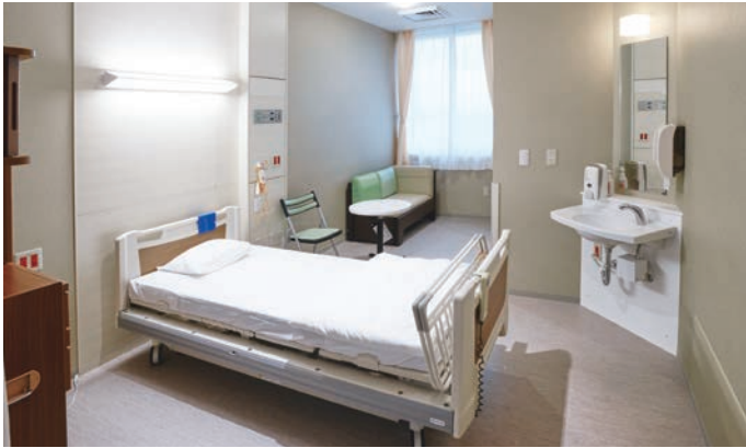
8Fの個室。部屋の中央には使いやすい洗面器も用意されている。床材にはノーワックスタイプで重歩行対応の単層シートを採用している。
