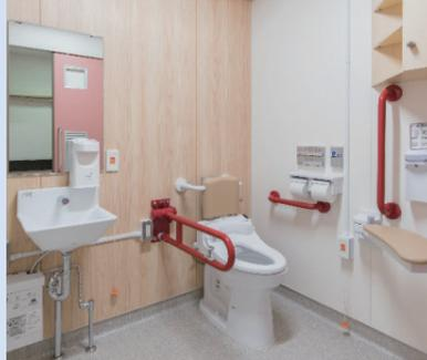
セラールウレテクト (アイカ工業) は傷が付きにくく、耐久性に優れた壁面パネルです。衝撃にも強く、ストレッチャーガードなどで車いすの脚部などが当たっても安心です。さらに、抗ウイルス・抗菌性能に優れているため、清掃が大変なトイレ壁面に最適です。豊富な柄と仕上げ対応により、あらゆる癒しの空間に対応します。
