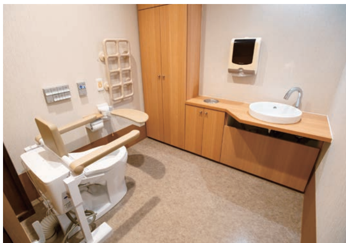
後方アプローチによって、車いすの利用者でも介助のしやすいトイレ。壁材、床材、収納、設備などが温かみのある色調で統一され、癒しの空間となっている。
