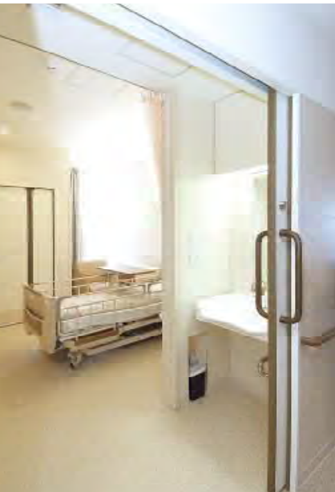
開口部が広くて明るい個室。トイレは部屋の奥に、洗面器は手前に備えられている。壁の下をくり抜いて双方から使えるゴミ箱も便利である。
