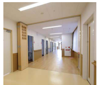
夜間はスタッフの見通しをよくするために、間仕切りを開放。廊下の手すりは肘で寄りかかれる形状にしている。
