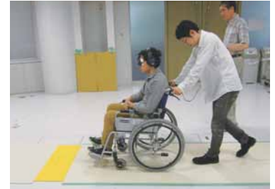
写真5: 車いすの振動計測実験
