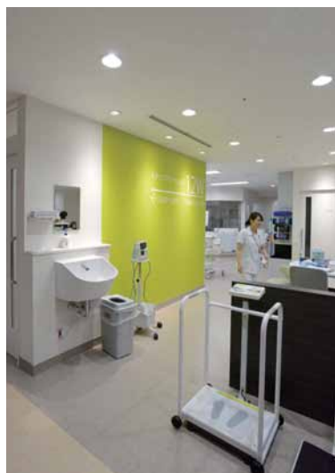
スタッフステーションに設けられたスタッフ用手洗器。
