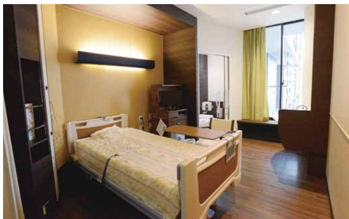
12F整形外科病棟の個室。床材にこだわり、木目調のノンワックス複層シートを採用している。
