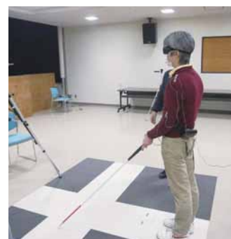
写真2: 警告ブロックの検知実験(静止状態)
