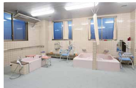
デイサービスの浴室には3つの個浴槽を用意。床には光触媒効果でぬめりを抑え滑りにくいハイドロテクトタイルを採用している。
