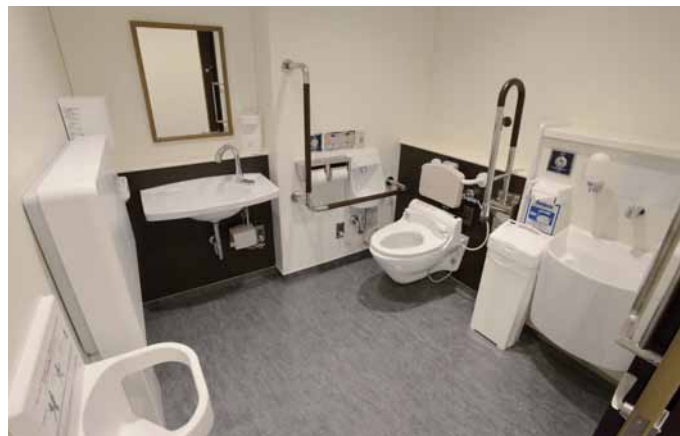
外来の「だれでもトイレ」。便器や手洗器の白色が際立つように、壁には濃い色を配している。
