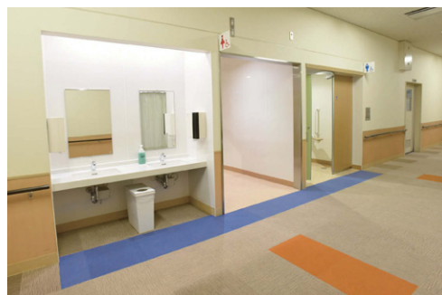
高齢者は車いす利用者も含めて視線が下を向く傾向にあるため、床の青いラインによるサイン表示で、トイレの場所が明確に分かるようにしている。
