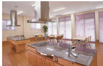
1Fのトレーニングルームに設けられた、車いすでも使いやすい昇降式の調理台。
