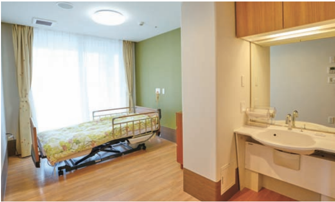
窓が広く明るい個室。車いすでも使いやすい洗面カウンターが設けられている。なお、施設内の床には、転倒対策としてクッション性のある長尺シートを採用している。
