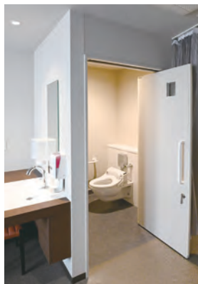
個室のトイレの扉には、押しても開き、引いても開く、2方向に開閉するスライドドアを採用。患者さんの状態によって使い分けができる。
