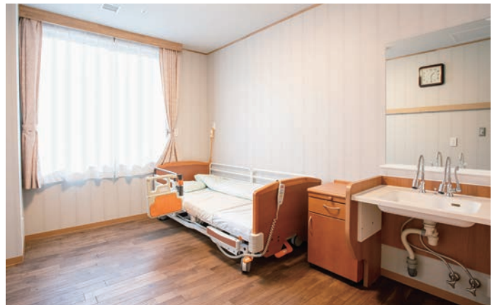
家庭的な落ち着きを重視して壁材や床材を選択している宿泊室。洗面器は利用者のプロフィールに合わせて、使いやすい高さに昇降させることができる。
