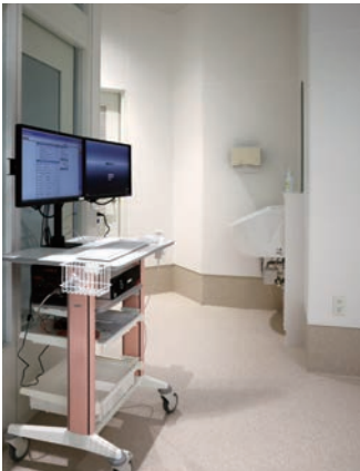
ICUのスタッフステーションの手洗いコーナーは、あふれ面の高さを850mmに設置することで腰をかがめずに利用でき、前傾姿勢による腰への負担を減らして快適に利用できる。
