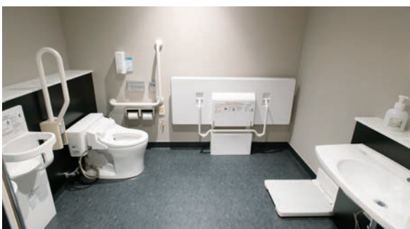
2F外来のバリアフリートイレ。はね上げ手すりやL型手すり、大型ベッドのほか、乳幼児連れにも配慮し、ベビーシート、ベビーチェア、フィッティングボードなどを完備している。
