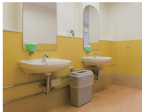
トイレのインテリアにおいては、器具と壁、床とのコントラストに配慮して視認性を高める必要があります。ここでは壁をツートンカラーにして爽やかさと明るさを演出しました。
