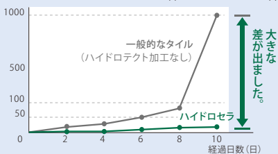
【防臭性能比較試験】アンモニア濃度 (ppm) (TOTO試験 ® ) 濃度 (ppm)
