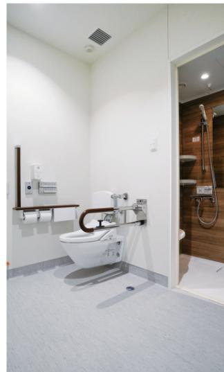
前室奥にある2居室用トイレ。奥には折り畳み式のチェアを備えたシャワールーム。清掃性を担保するために壁掛け式便器を採用し、シート床材を壁面まで巻上施工しているため掃除がしやすく衛生的。
