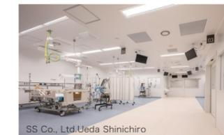
2階HCUには「パンデミックモード」があり、一部区画を感染症専用集中治療室に運用変更できるほか、同一空間内での気流制御が可能である。感染症専用集中治療室には感染症専用エレベータからの隔離動線が計画されている。
