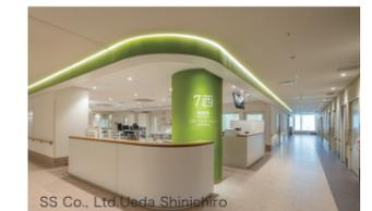
通常時（左）のスタッフステーションは、目隠しのよいオープンカウンターとなっている。また、サインは、光の連続や壁面の色彩によるウェイファインディングシステムを導入。行先表示は目立つ色と大きな文字で廊下の角々に配置し視認性を高めた。パンデミックモード時（右）は垂れ壁部のカーテンレールにビニールカーテンを掛け、目張りすることで区画し、容易に清潔区域と汚染区域を区画する。
