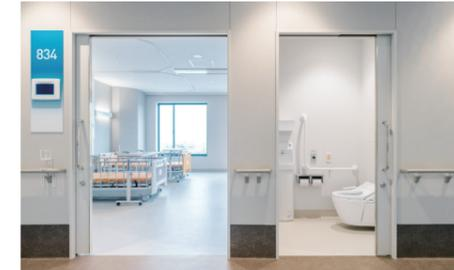
ベッドから近い位置にあり、プライバシーにも配慮した分散型（共用）トイレを採用した4床室。廊下を出て隣の扉がトイレになっている。清掃性の高い壁掛け式の便器を採用。手洗い器も設置されている。
