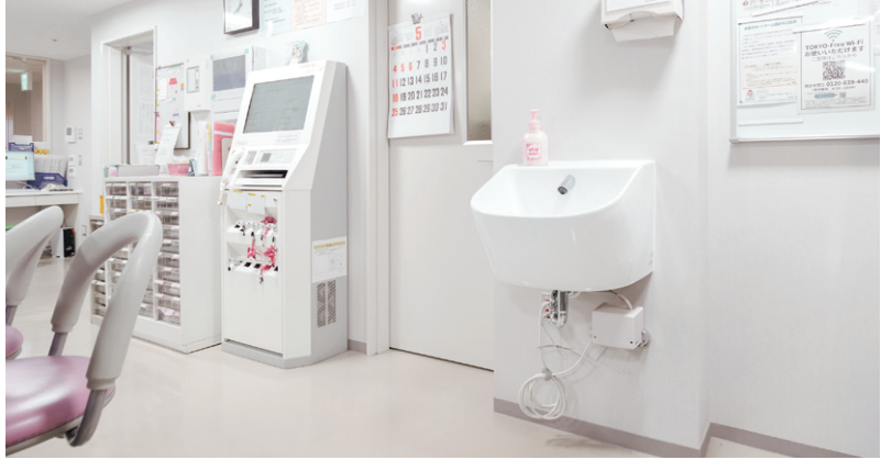
3階小児病棟のスタッフステーション。2方向で廊下に接していて、それぞれの入り口付近に手洗いが設置されている。肘まで洗えるボウルと自動水栓で手指衛生を管理。
