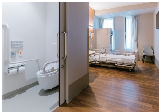
8階病棟の個室。出入り口近くの引き戸はトイレの入り口。ベッドは離床センサーが取り付けられているほか、ベッド脇のモニターは患者の情報を閲覧できる。モニター下のセンサーにデバイスをかざすだけで計測した体温・血圧・酸素飽和度、血糖値を電子カルテに送信できる。病室には各室それぞれに加湿・換気機能付きのエアコンが設置されている。
